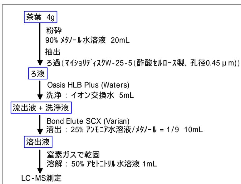
図3 茶葉試料の前処理
